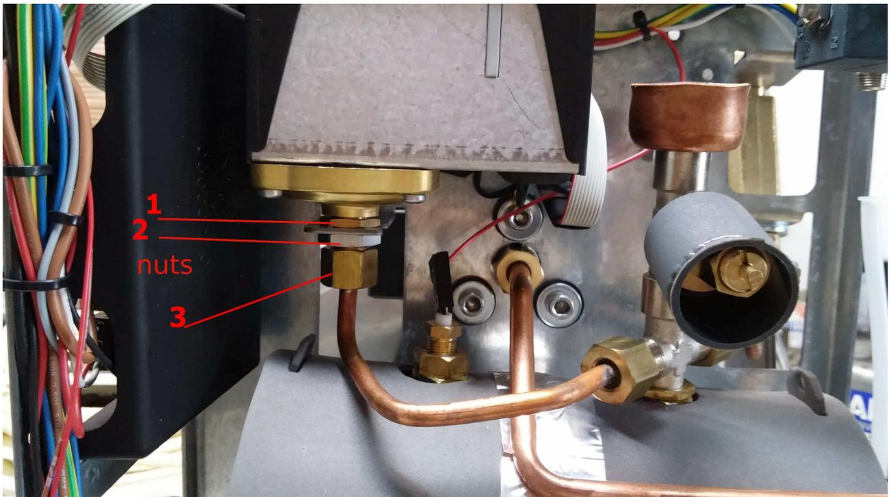
Con una chiave n° 18 serrare a fondo il dado contrassegnato con "1" al corpo del pressostato Sirai
